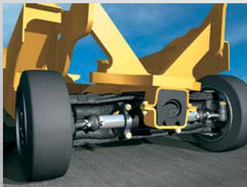
Вверху: HSM™ (Механизм поддержания устойчивости Hyster) уменьшает наклон погрузчика, и повышает его поперечную устойчивость. Конструкция позволяет уверенно перемещаться по неровной поверхности.
